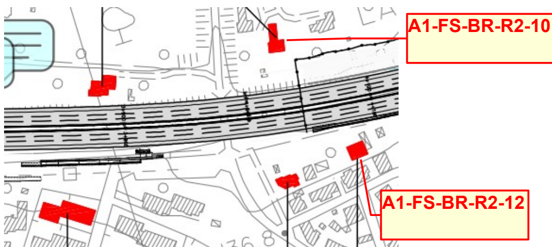
Figura 2: planimetria del cantiere WBS GA01 con le postazioni di monitoraggio (fonte: tavola grafica allegata al PMA).
