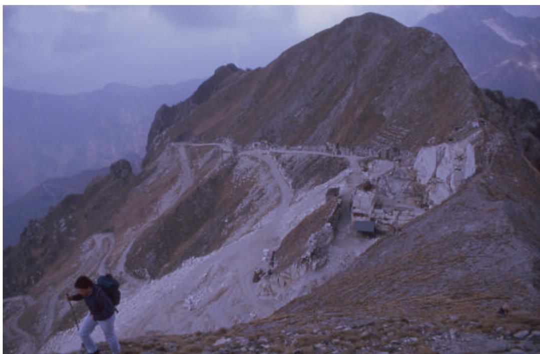
Figura 6 – La cava dei Tavolini. Localizzata in una delle zone più elevate del m. Corchia, nonostante le attenzioni e le corrette procedure di scavo, non può non costituire una perenne fonte di rischio di contaminazione delle acque che circolano all'interno del massiccio carsico.
