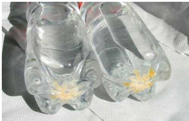
Figura 5 – Alterazione del polimero in PET di bottiglie di acqua minerale per contatto con benzina
