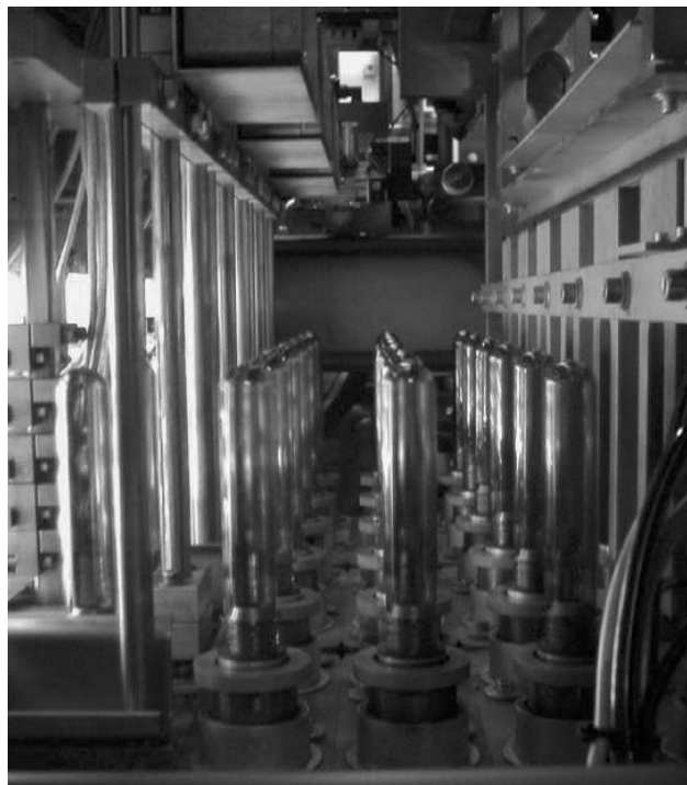
Figura 3 – Estrusione di preforme per la produzione di bottiglie in PET destinate all'imbottigliamento di acque minerali
