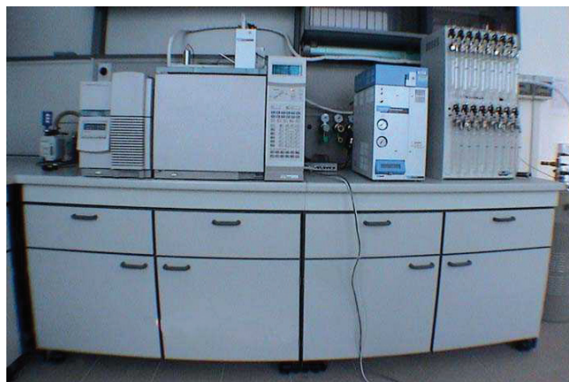
Fig.2 - Gascromatografo, rilevatore massa a quadrupolo, autocampionatore con sistema purge & trap con criofocalizzatore
