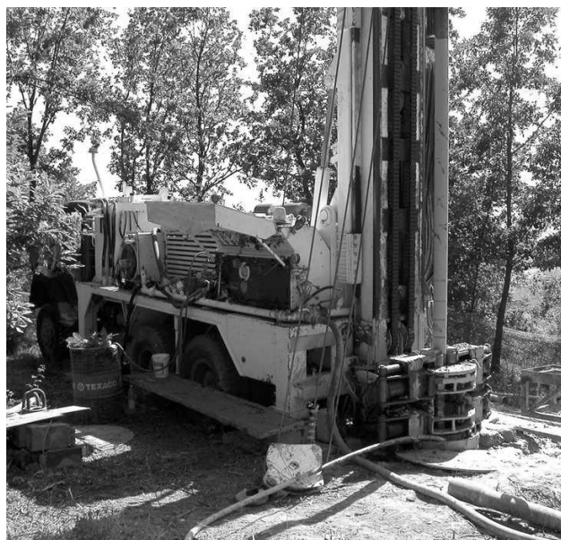
Figura 1 - Perforazione di un pozzo in un’area di concessione mineraria
