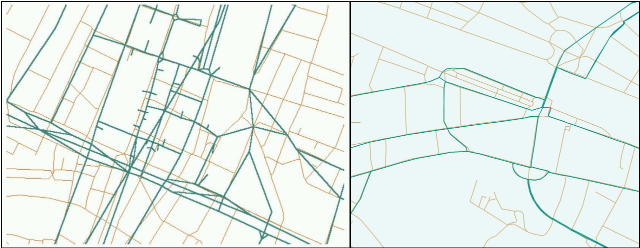
Figura 1: Confronto tra l'esempio citato nella GPG (a sinistra) ed i grafi rappresentanti le sorgenti di traffico inserite nel modello acustico (a destra). In marrone è rappresentata una rete stradale ben modellata, in verde una rete stradale rappresentata in maniera non accurata.
