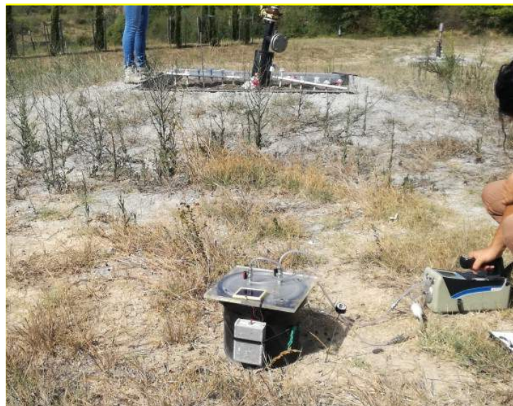
Misure macro componenti biogas con camera d'accumulo statica
