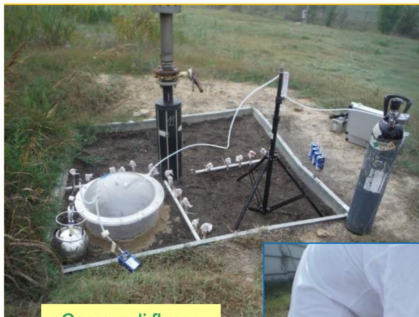
Camera di flusso dinamica, canister e fiale
