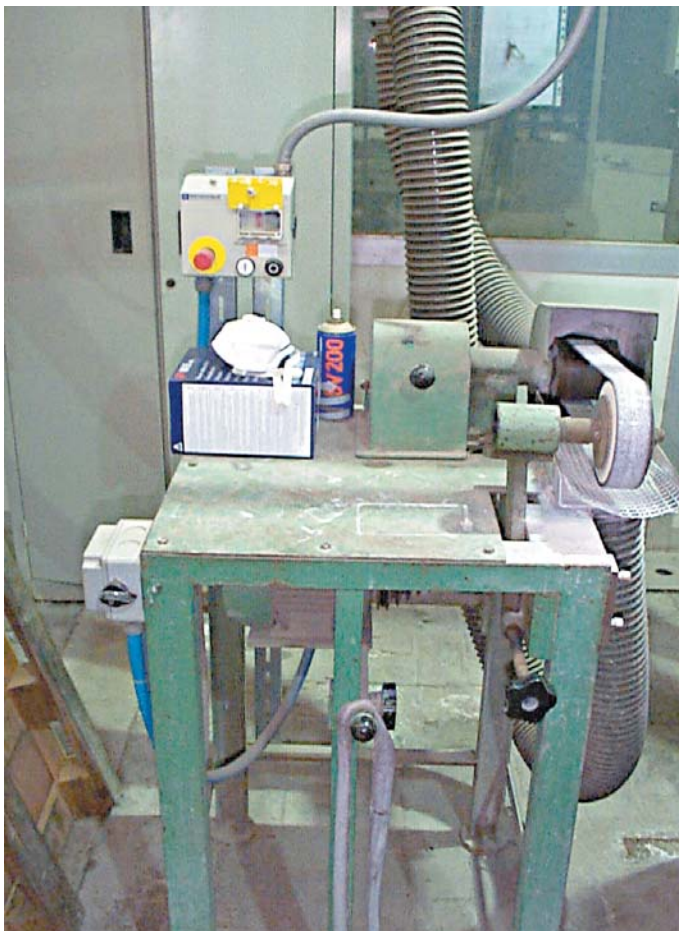
Foto 12 Levigatrice con impianto di aspirazione localizzata
