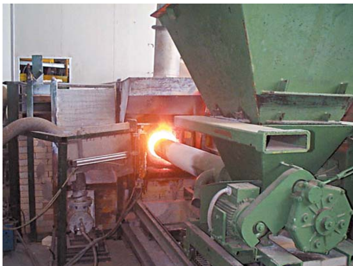
Foto 6 Infornaggio in forno a crogiolo, inserimento della miscela mediante coclea
