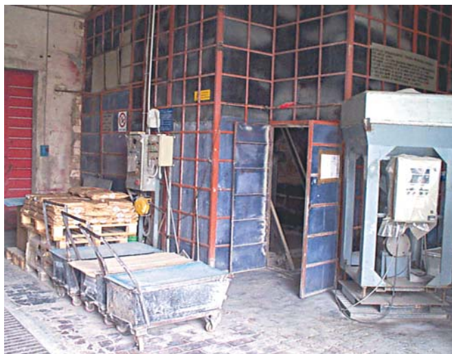
Foto 2 Box chiuso sotto aspirazione per preparare la miscela vetrificabile
