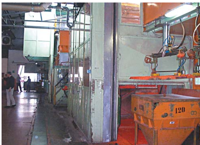
Foto 3 Impianto chiuso di composizione automatizzato e tramoggia di trasporto
