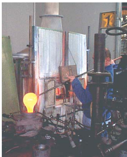
Foto 7 Colata del cristallo fuso nello stampo abbozzatore
