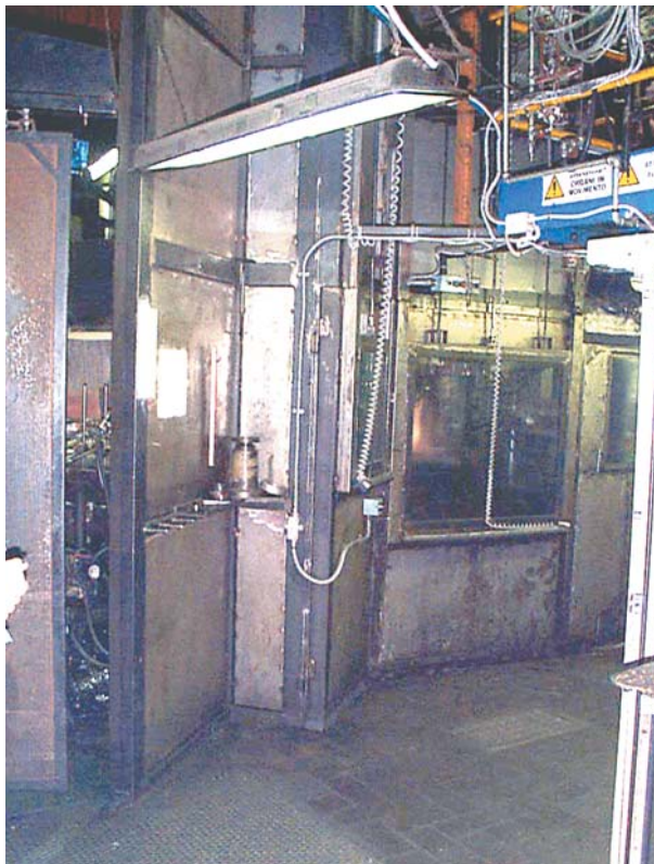
Foto 8 Pannello fonoassorbente alla pressa formatrice di una linea automatica
