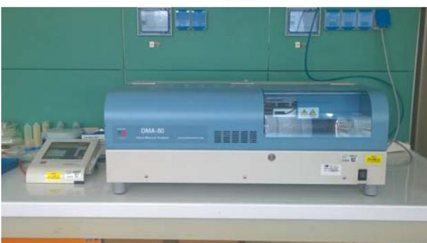
L'equivalenza tra le prestazioni delle tre apparecchiature utilizzate (CETAC, ICP MS e DMA 80) è stata valutata durante le campagne dal laboratorio tramite prove in parallelo svolte su più campioni.
