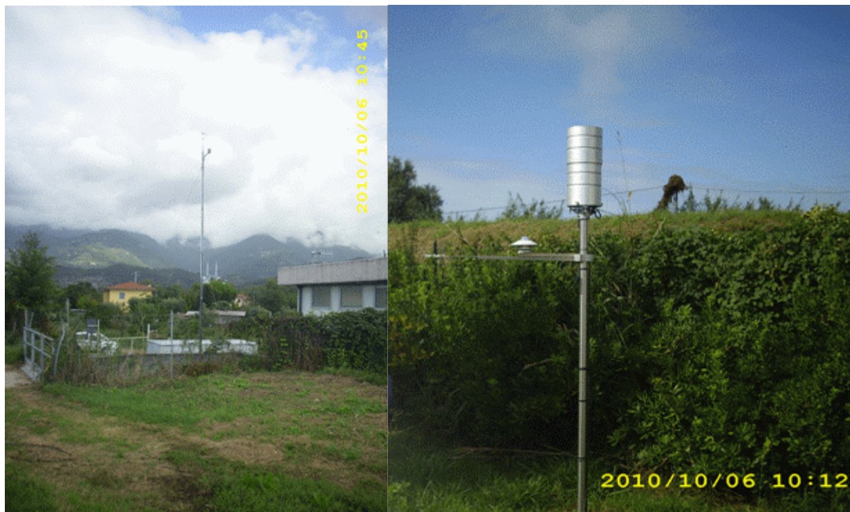
Figura A2: Foto della stazione meteo. A sinistra il palo anemometrico sul cui sfondo si osserva l'impianto TEV mentre a destra si individua l'edificio del Consorzio di Bonifica della Versilia; nella foto a destra la palina su cui sono posizionati i sensori radiometrici (netto e globale) ed il pluviometro.
