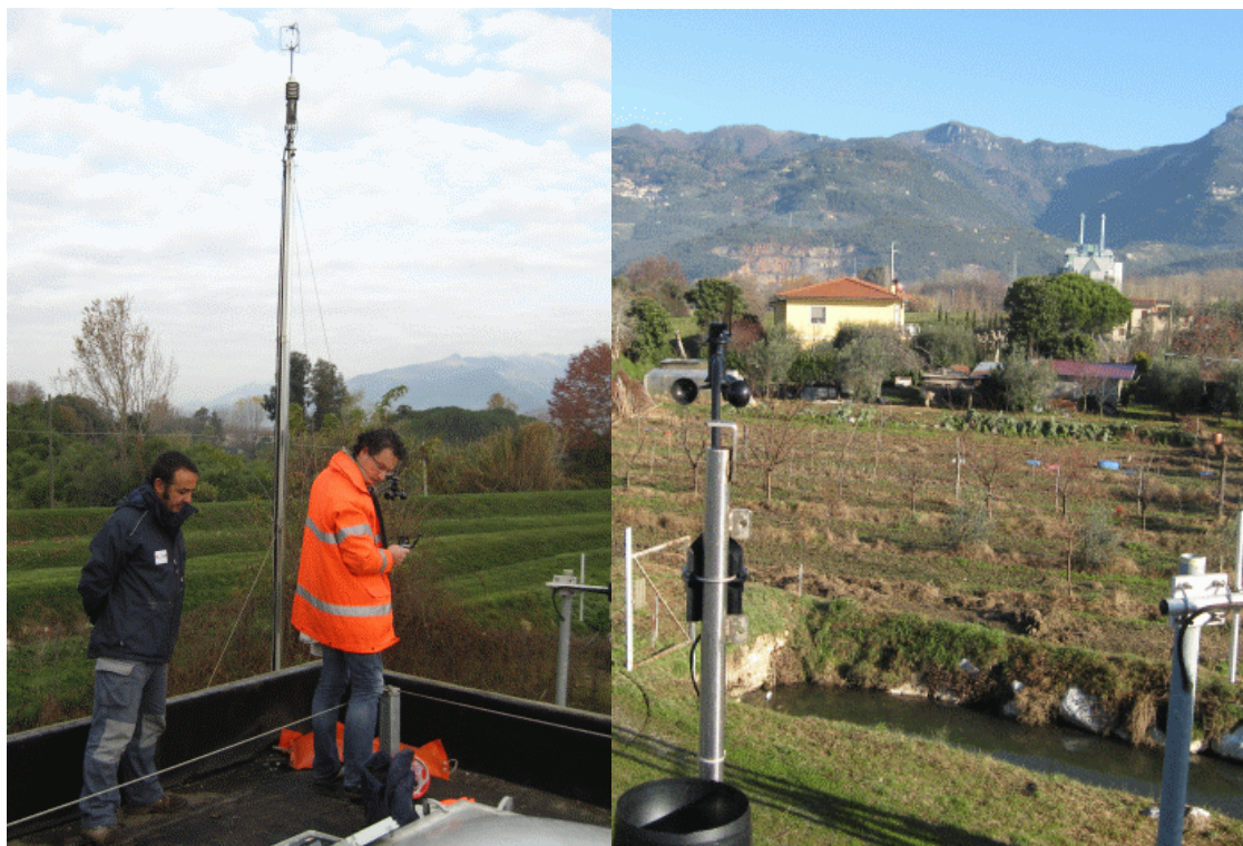
Figura AA4: A sinistra la fase di montaggio dell'anemometro ARPAT; nella foto è visibile l'altezza di questo sia rispetto al tetto dell'edificio che rispetto alla strumentazione di quello VEOLIA-TEV. A destra la foto rappresenta il dettaglio dell'anemometro ARPAT con sullo sfondo l'impianto TEV.
