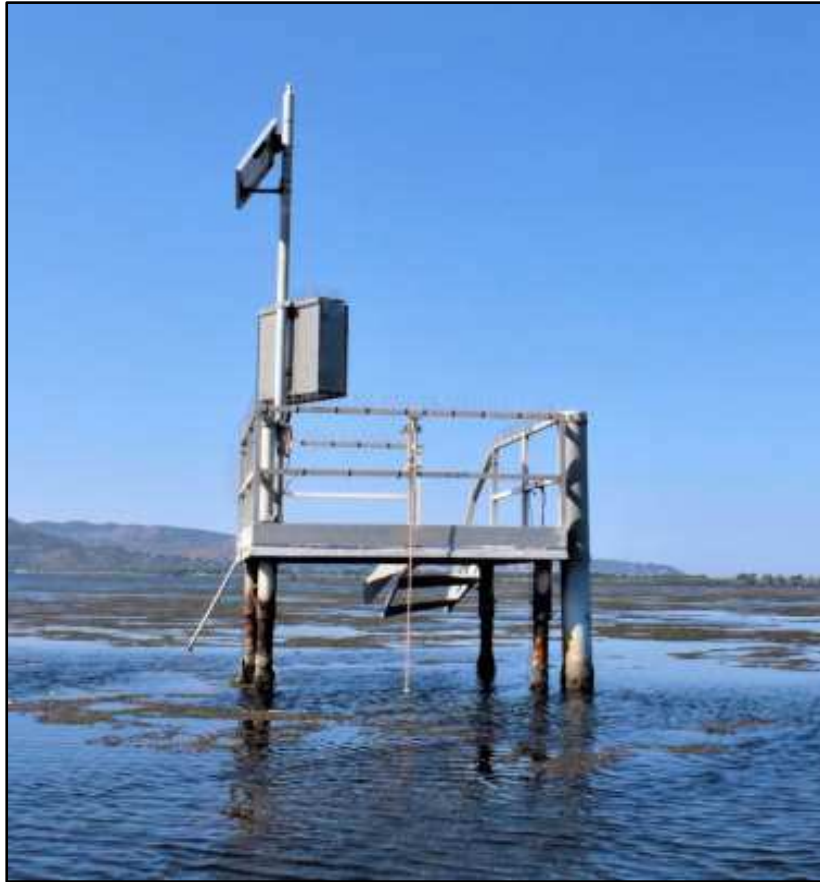
Figura 6– Esempio di stazione di monitoraggio fissa posizionata nella Laguna di Orbetello
