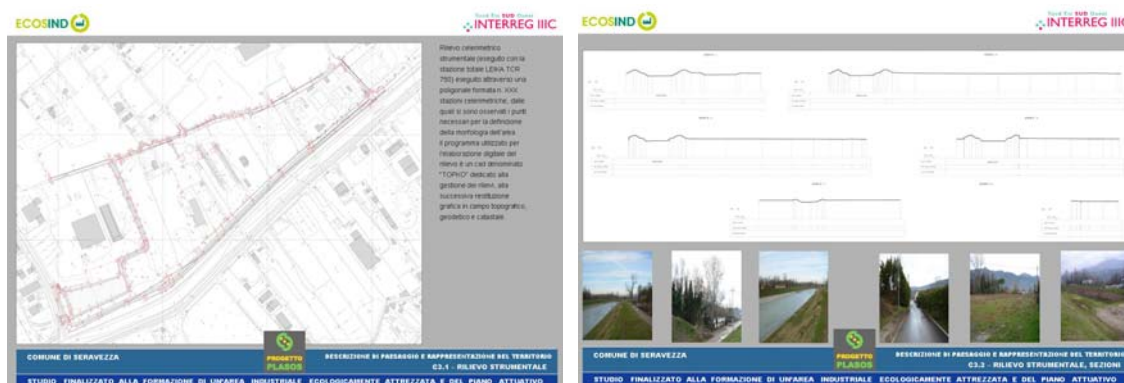
Rilievo strumentale e restituzione grafica in formato vettoriale, originale in scala 1:5.000 a sinistra planoaltimetria, a destra sezioni significative
