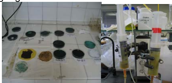
Photos 1 et 2 : Précipitation du chrome VI (à gauche) et piégeage du chrome dans une résine (à droite).
