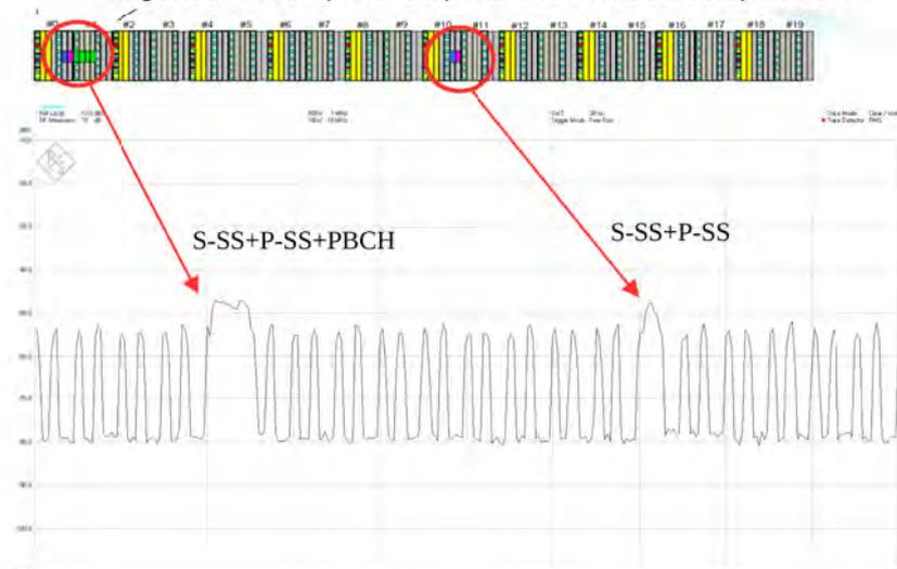
Figura 6 – esempio di acquisizione in modalità *Span Zero* con potenza ricevuta durante la trasmissione del canale PBCH inferiore a quella trasmessa durante la trasmissione dei canali P-SS e S-SS
