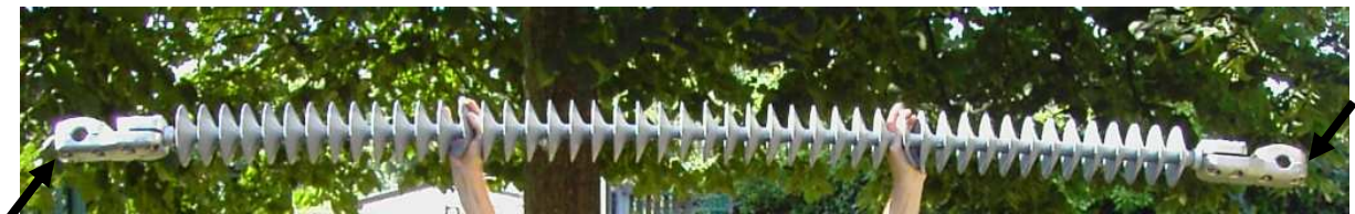
Esempio di isolatore in materiale composito di lunghezza pari a 2,2 m, installato sulla linea n. 024 per compattare i conduttori. Sono stati evidenziati gli attacchi al conduttore che rendono maggiore la lunghezza totale di tale modello di isolatore.
