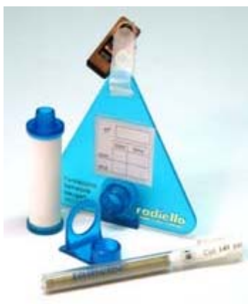
Fig.1 – Il campionatore passivo Radiello
