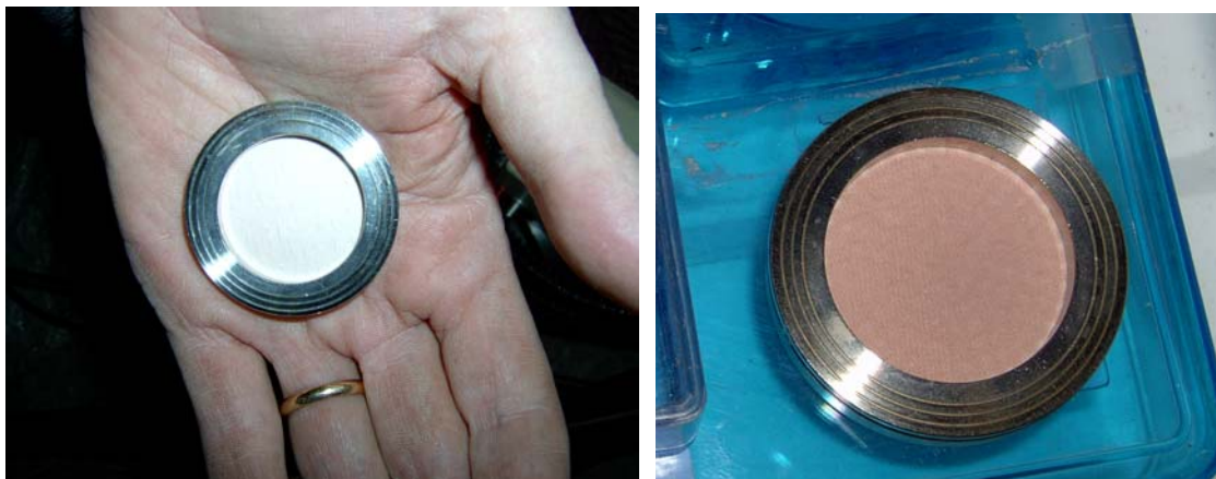
Fig. 4.13 - Membrana su supporto di alloggiamento
