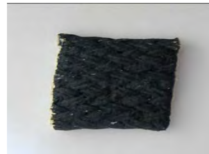
Pezzo di cavo rivestito esternamente con una maglia di filo di rame con all'interno amianto crisotilo trattato con grasso
