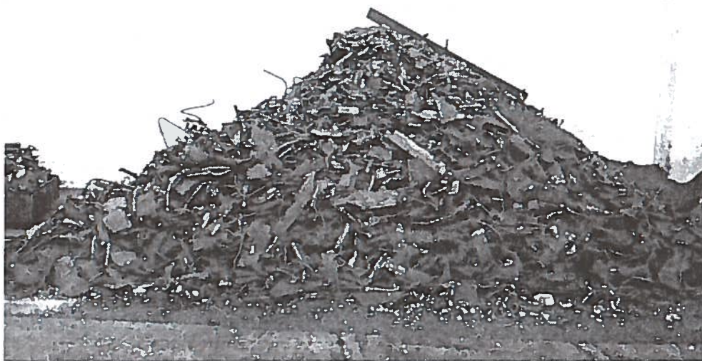
Foto 3 Rottame di ghisa in attesa del caricamento in forno
