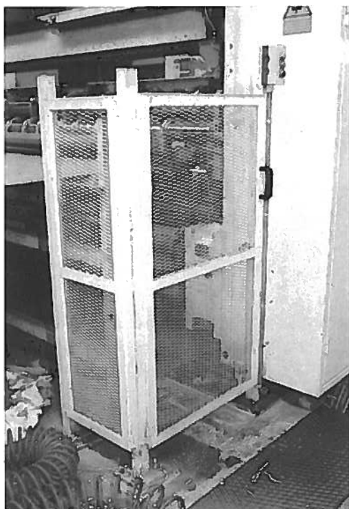
Fig. 31 Barriera di protezione alla taglia-cordona.
