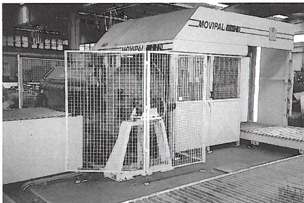
Fig. 65 Barriere laterali di protezione del pallettizzatore automatico.
