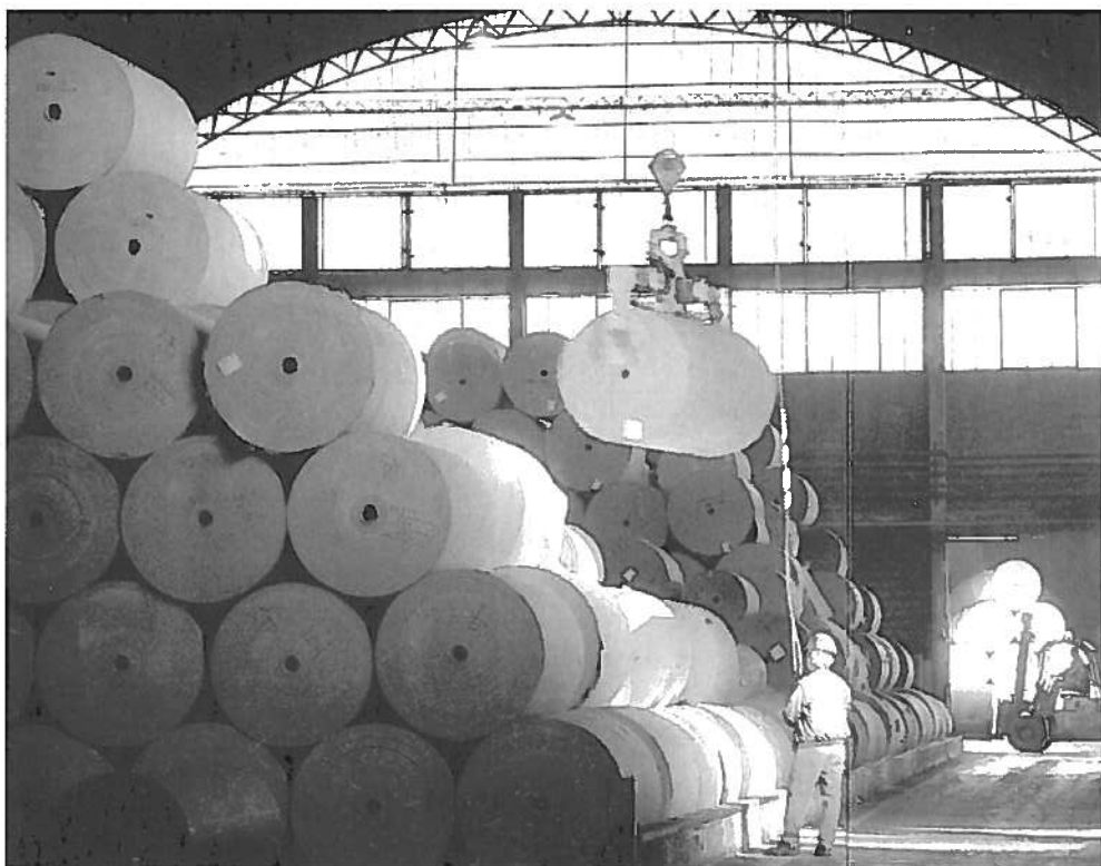
Fig. 7 Movimentazione delle bobine in caso di immagazzinamento orizzontale.
