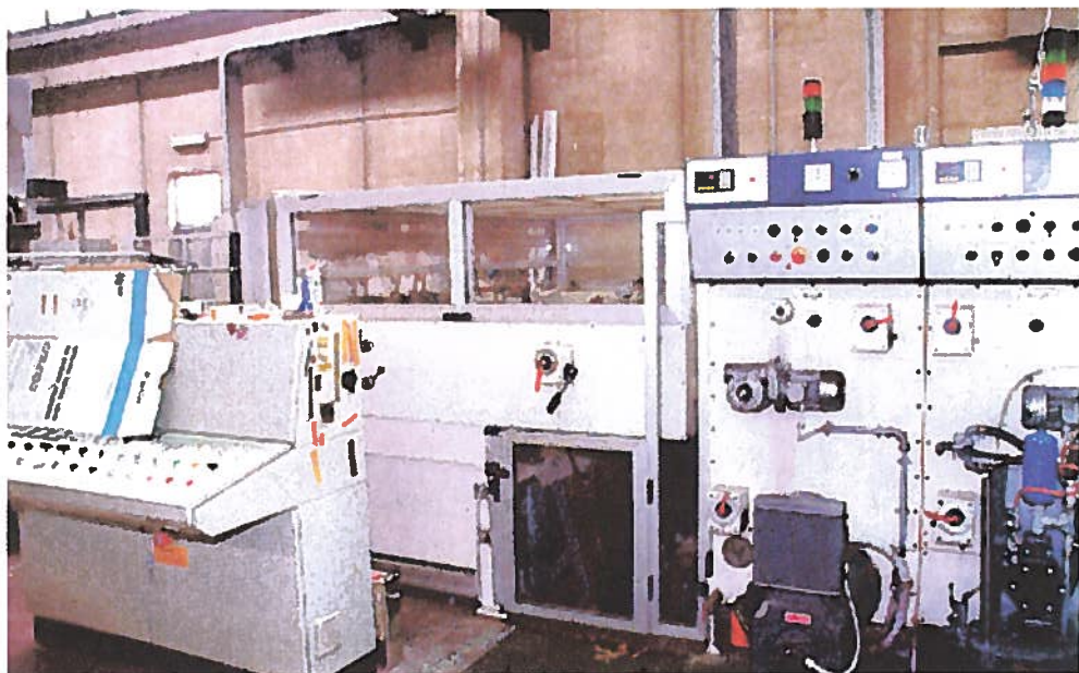
Fig. 58 Particolare degli schermi di protezione alla fustellatrice.
