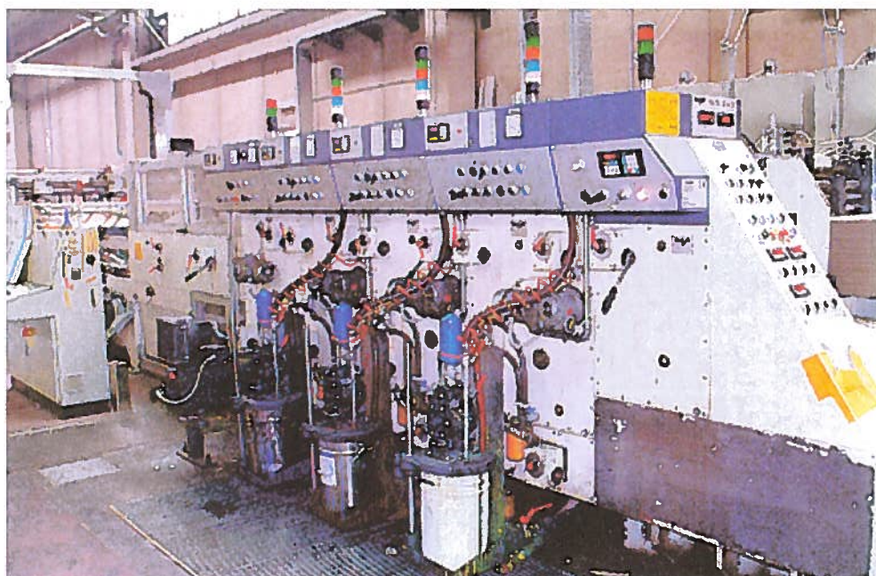
Fig. 60 Sezione di stampa della fustellatrice. Si noti il pavimento grigliato sotto i contenitori dell'inchiostro.
