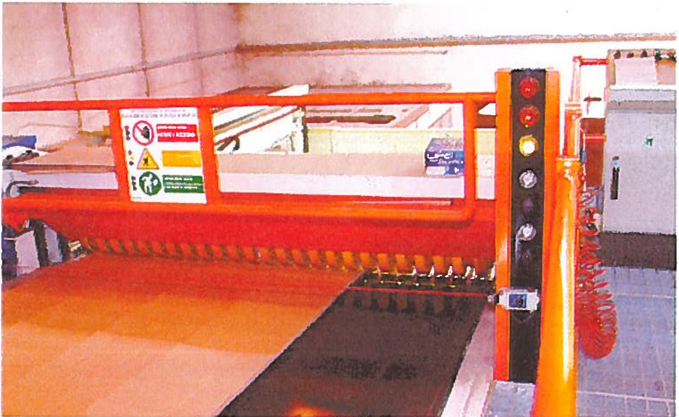
Fig. 35 Alimentatore del raccoglitore - impilatore (si noti il filo di protezione di colore rosso).
