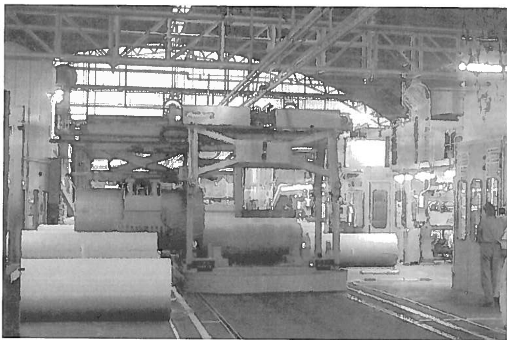
Fig. 39 Robot su rotaia per la movimentazione delle bobine nei locali della macchina continua ondulatorice.
