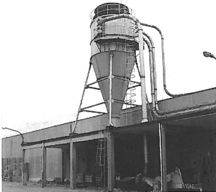
Fig. 70 Ciclone di separazione delle polveri fini dai ritagli di cartone; sotto il ciclone c'è la pressa.
