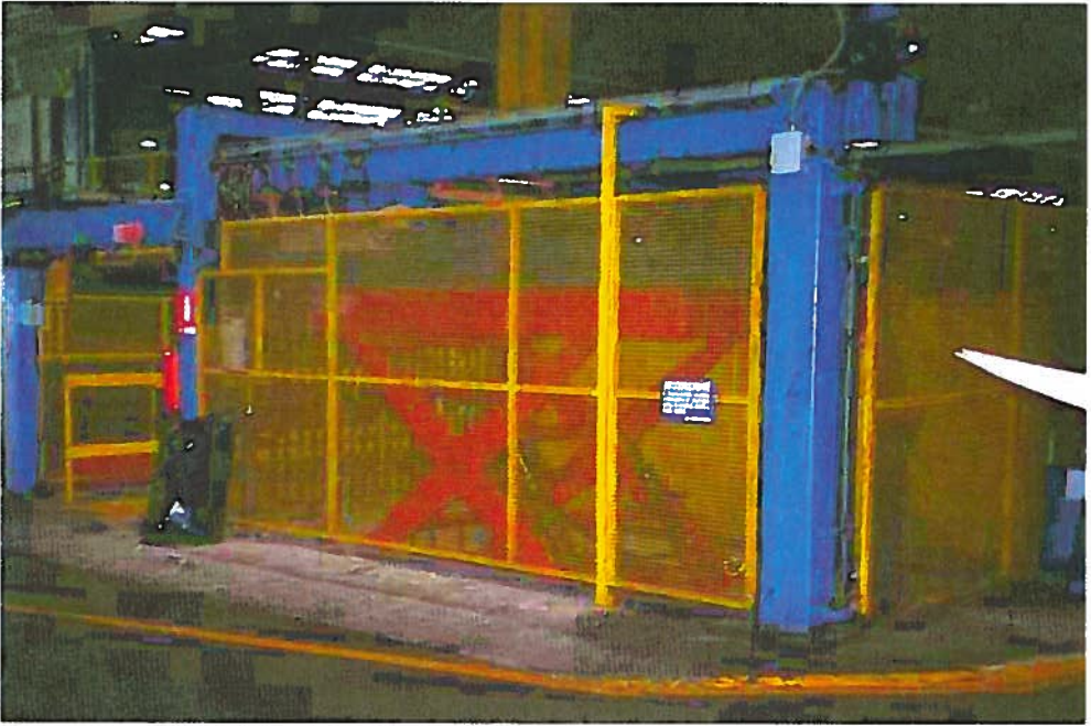
Fig. 34 Impilatore visto dal retro protetto mediante barriere fisse
