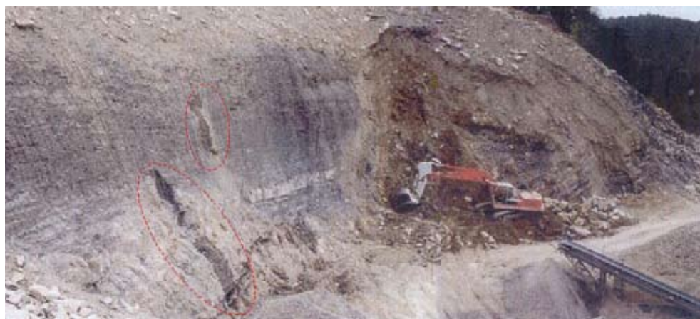
Foto 3 - Fronte di cava con emergenze idriche
