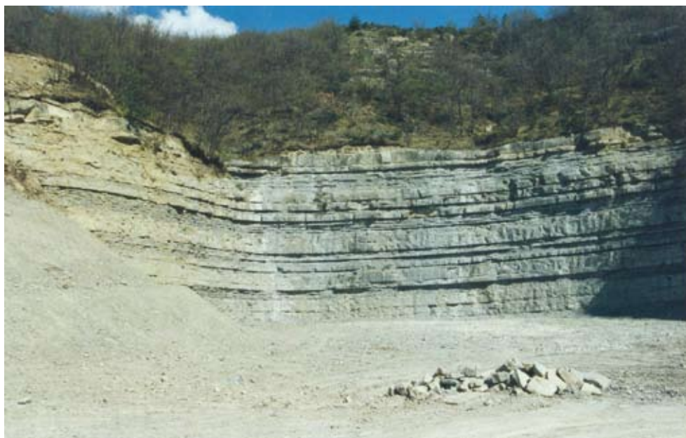
Foto 9 - Cava a fronte unico per l'estrazione di pietra arenacea
