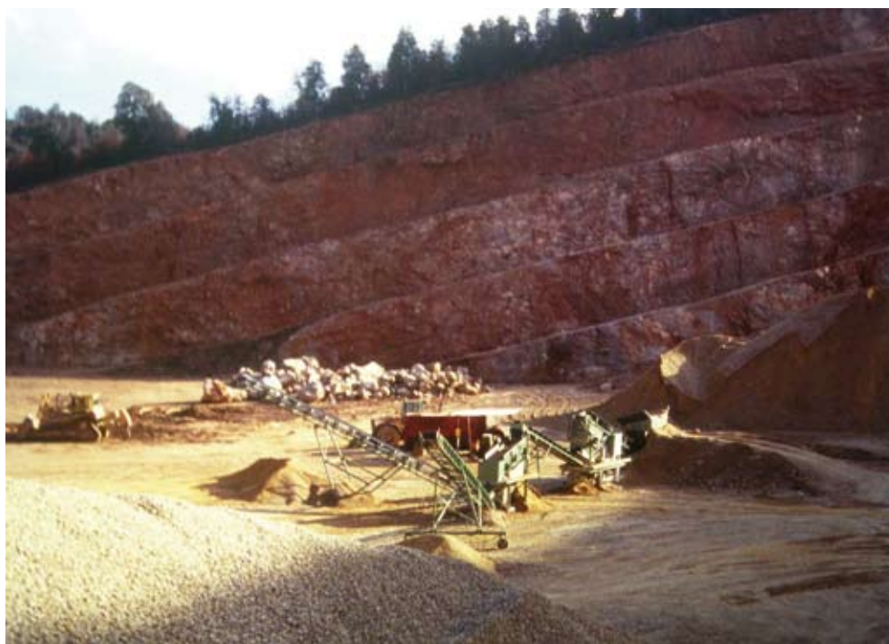
Foto 5 - Impianti di lavorazione (frantumazione, selezione) in cava di materiali litoidi
