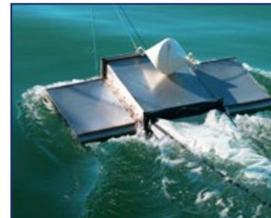
*Retino manta per il campionamento delle microplastiche*
