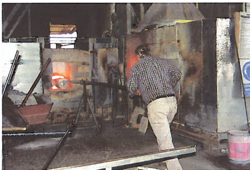
Foto 12b - Caricamento di un forno con bilancino
