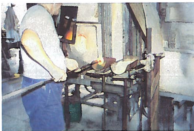
Foto 17 - Impolveramento pallina con ossidi coloranti
