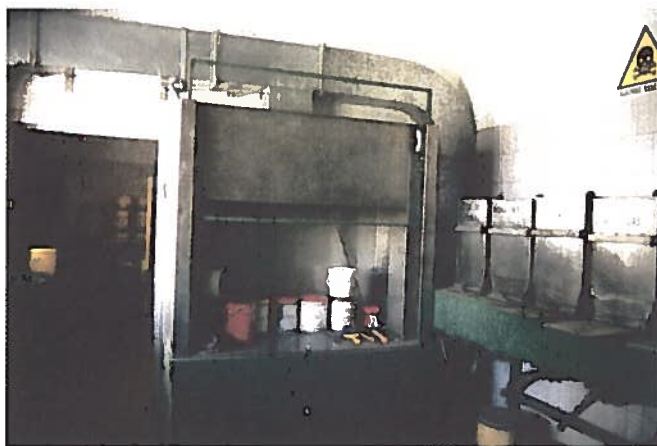
Foto 9 - Stazione di preparazione della cassetta con cappa aspirata e bilancia scorrevole su binario sottoposto ad aspirazione localizzata.
