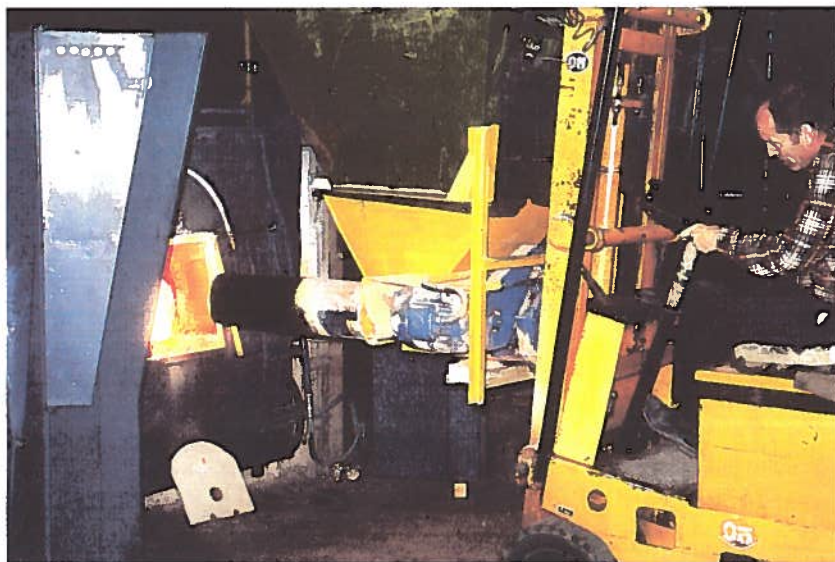
Foto 10 - Caricamento di un forno con informatore a coclea
