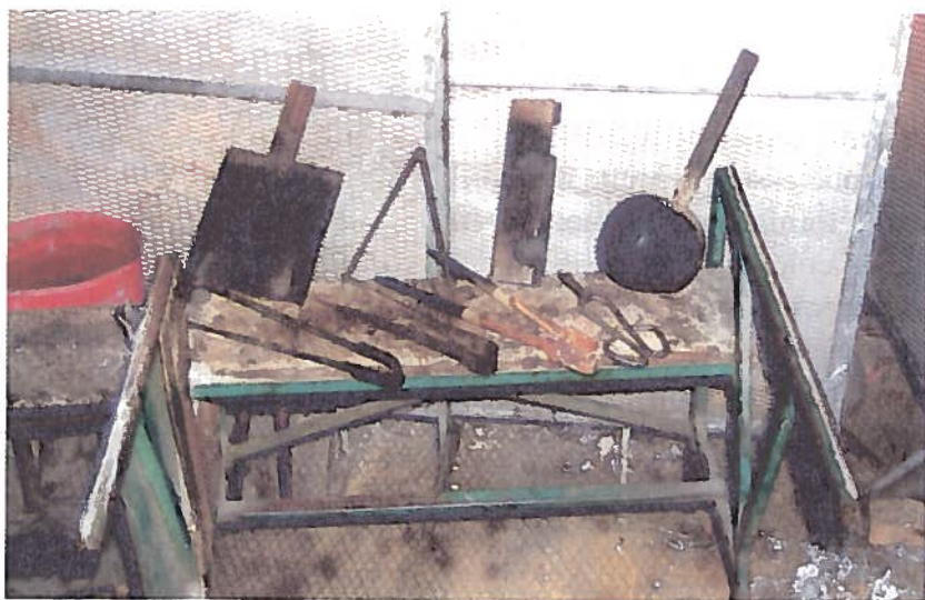
Foto 14 - Scanno del maestro vetraio con arnesi: (da sin.) pinza a molla, paletta, compasso, forbici, "gnacchere" "maioscio".
