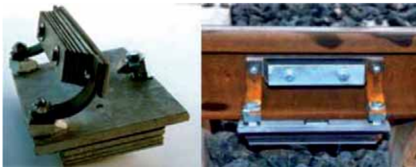
Figura 38 C - Assorbitore accordato in frequenza continuo incollato Corus and Edilon [da Q-City TIP4-CT-2005-516420, “Quiet City Transport” DELIVERABLE D3.9, 2006]
