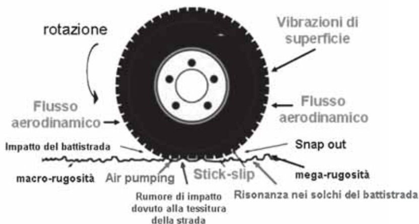
Figura 11 - Meccanismi di generazione del rumore dovuto al contatto ruota-strada
