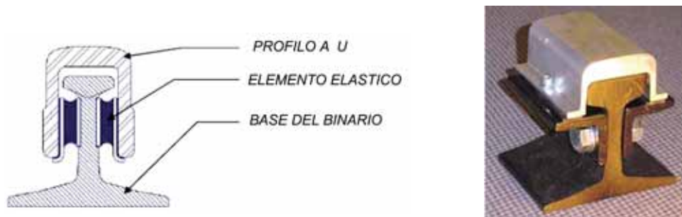
Figura 38 G - Binario UIC 60 annegato in profilo scatolare d'acciaio contenente materiale viscoelastico [da Q-City TIP4-CT-2005-516420, “Quiet City Transport” DELIVERABLE D3.9, 2006]
