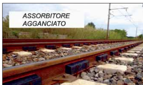
Figura 36 - Assorbitori con fissaggio meccanico e incollati [da Benton D., Engineering Aspects of Rail Damper Design and Installation , 2006]
