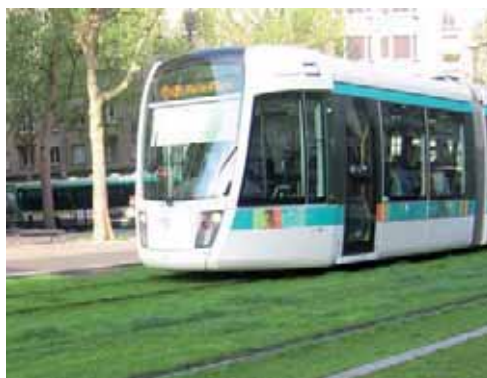
Figura 32 - Esempi di binario annegato, su linee urbane: a sinistra, in pavimentazione in pietra [da Q-City TIP4-CT-2005-516420, “Quiet City Transport”, DELIVERABLE D3.9, 2006]; a destra, in terreno vegetale.
