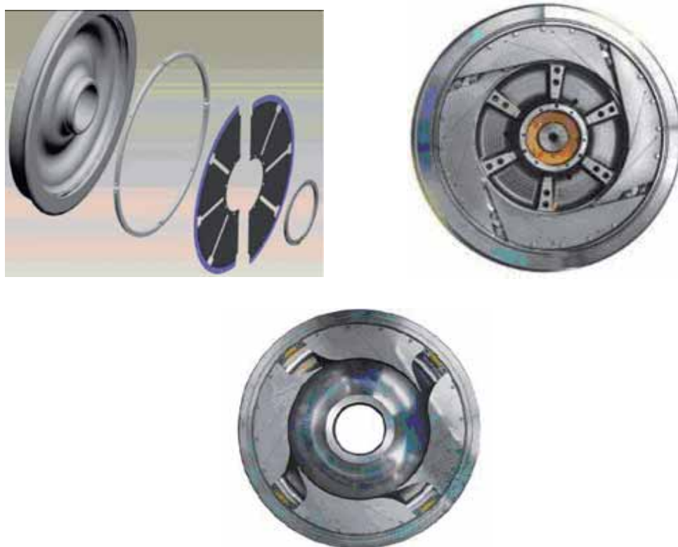
Figura 29 - Esempi di assorbitori acustici sulle ruote. A sinistra, il dispositivo HYPNO, sviluppato nell'ambito del Progetto Europeo SILENCE, da parte di Lucchini RS S.p.A. A destra, ruota per carro ferroviario C-Shape con il silenziatore modulare GALENE (sempre di Lucchini RS S.p.A) e, in basso, ruota elastica per tram Combino (Siemens) con dispositivo GALENE.
