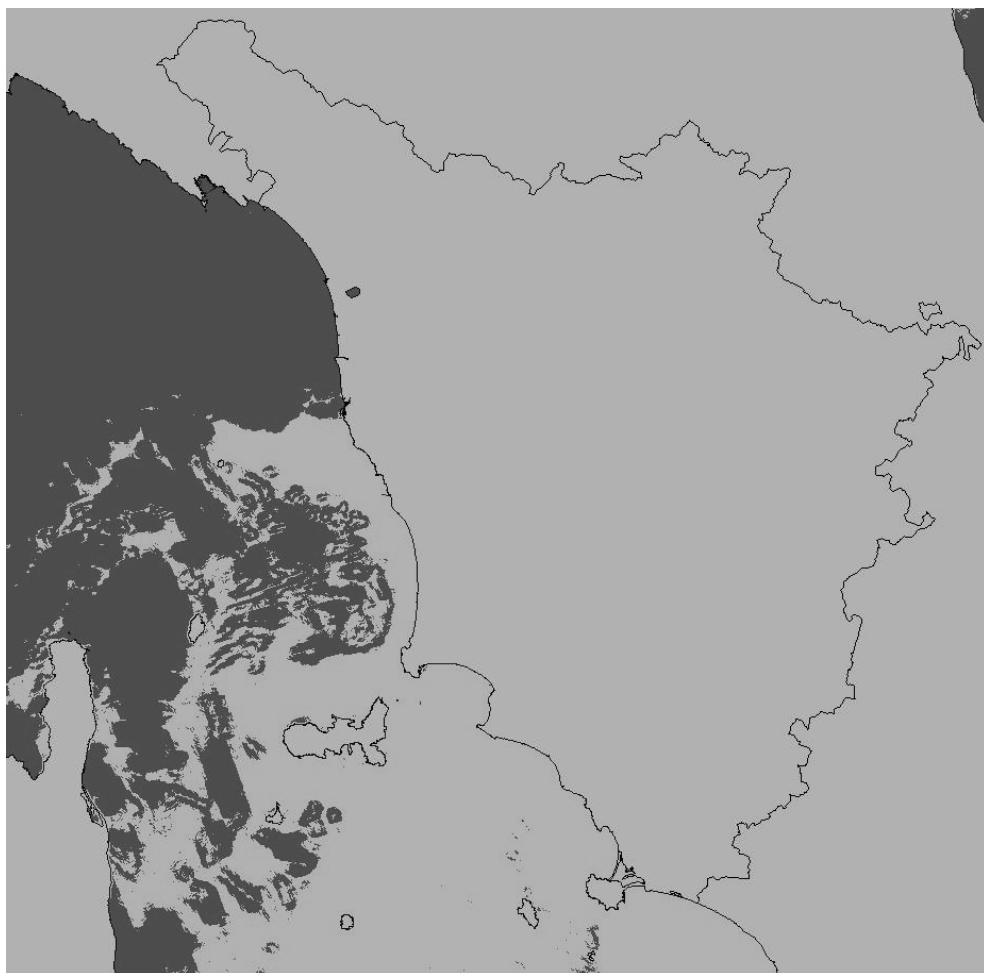
Fig. 17.7 File xb229812.CCL, maschera Terra-Mare-Nuvole dell'immagine del 25 ottobre 2002 delle ore 12:05 UTC, telerilevata col sensore AVHRR a bordo del satellite NOAA16. L'identificazione delle nubi è stata svolta con la procedura automatica descritta in paragrafo 17.3; la parte scura identifica le nubi
