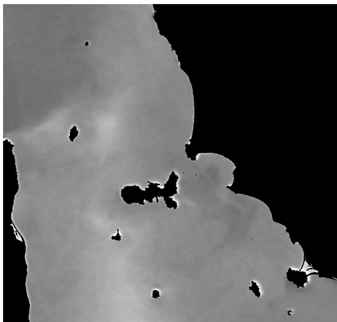
Fig. 14.10 Temperatura superficiale del mare (SST), ottenuta il 12.07.2002 alle 12:58 UTC (NOAA16), georeferita in proiezione Mercatore formato "Arcipelago 02" (8 bit/pixel, 800 byte di testata). Dimensioni immagine 1156x1101 pixel, su carta 16.3x15.5 cm con scala 1:1.000.000 e risoluzione stampante dpi 180
