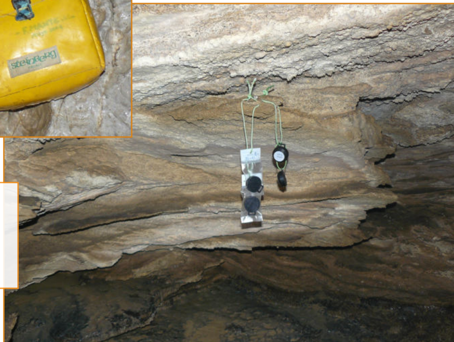
Fig. 7.4 - Rivelatori a tracce nucleari CR39 posizionati lungo una galleria del Complesso carsico del monte Corchia (sommità pozzo della Gronda).
