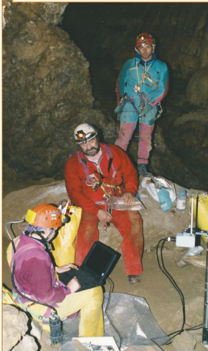
Fig. 2.3 - Acquisizione di dati dalla prima strumentazione impiegata per il rilevamento dei parametri meteorologici (studio del microclima ipogeo) posizionata lungo la Galleria del Venerdì (1998).
