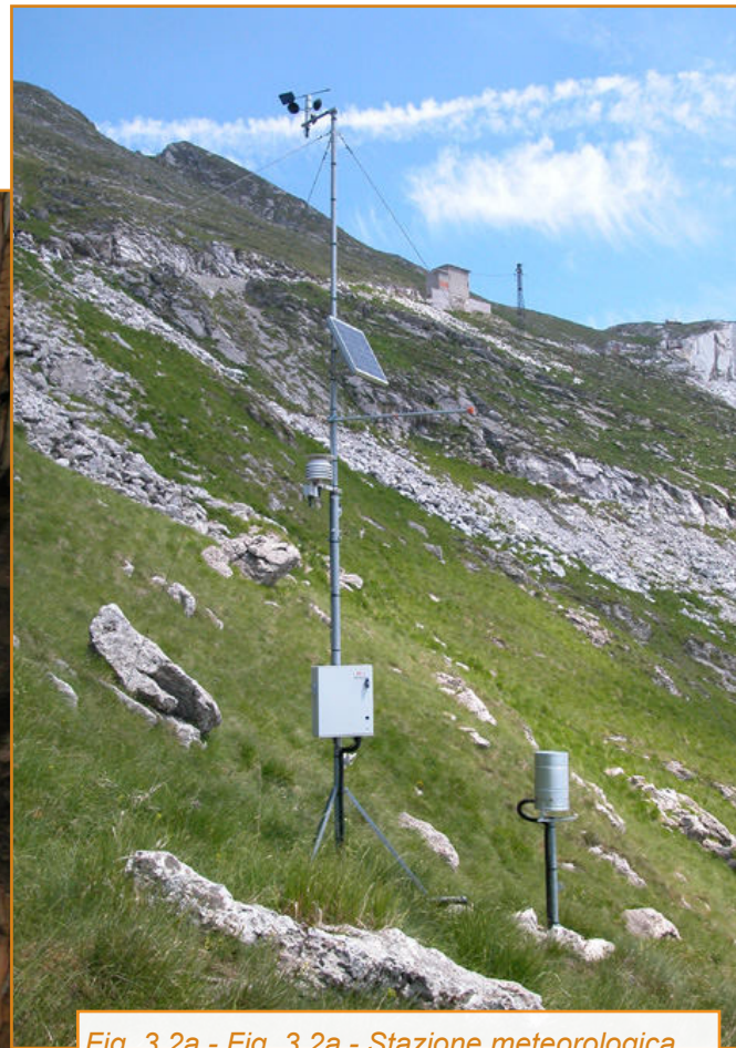
Fig. 3.2a - Stazione meteorologica esterna situata lungo la strada che conduce alla cava dei Tavolini, sul versante sud-occidentale del monte Corchia, a quota 1470 m.
