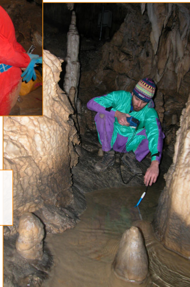
Fig. 4.9 – Misura del pH nelle acque del laghetto della Galleria Bassa delle Stalattiti.
