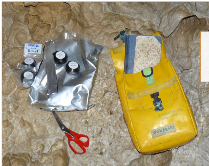
Fig. 7.3 - Rivelatori a tracce nucleari CR39 utilizzati per il monitoraggio del radon entro il Complesso carsico del monte Corchia.
