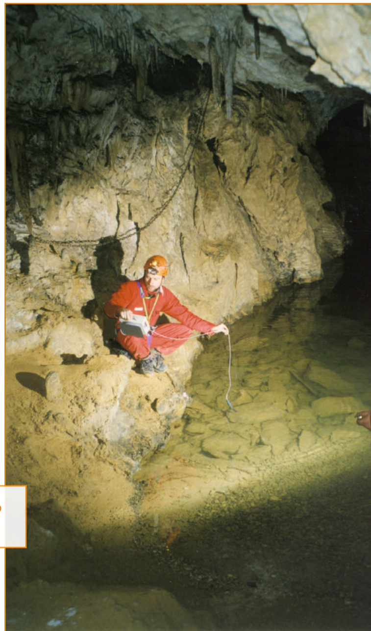
Fig.4.15 - Operazioni di misura dell'ossigeno disciolto entro l'acqua del laghetto del Venerdì.
