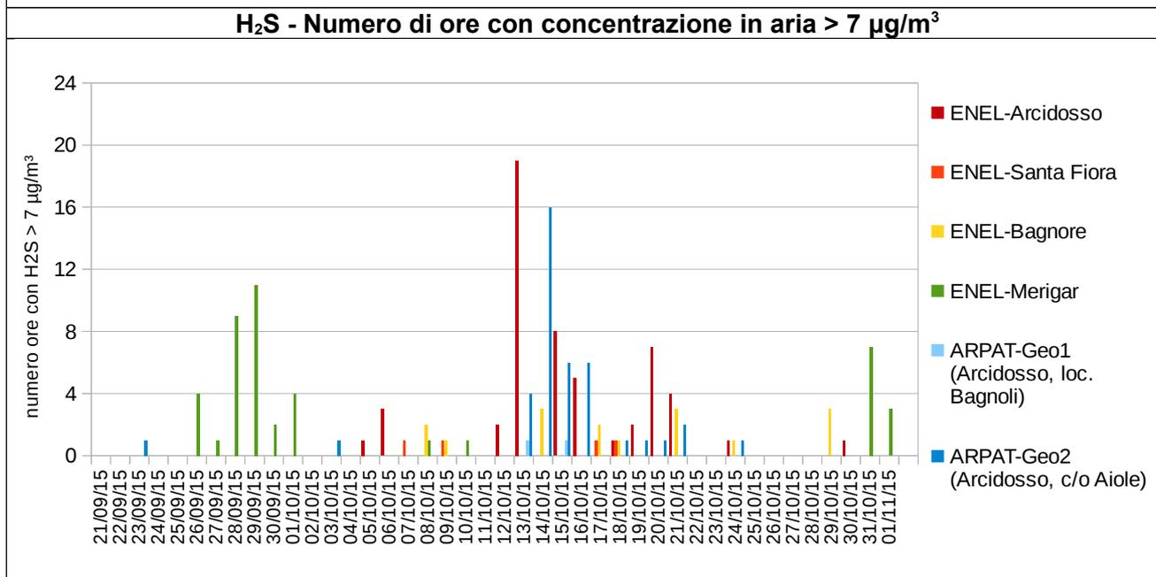
Nella settimana dal 26/10 al 1/11/2015, dopo gli interventi di manutenzione effettuati i recenti blocchi AMIS (l'ultimo il giorno 31/10 dalle ore 12:38 alle ore 13:50 al binario di Bagnore), in tutte le stazioni si sono registrate concentrazioni di H<sub>2</sub>S in diminuzione, rispettando il limite di riferimento indicato dalle Linee Guida del WHO (150 µg/m<sup>3</sup>).
