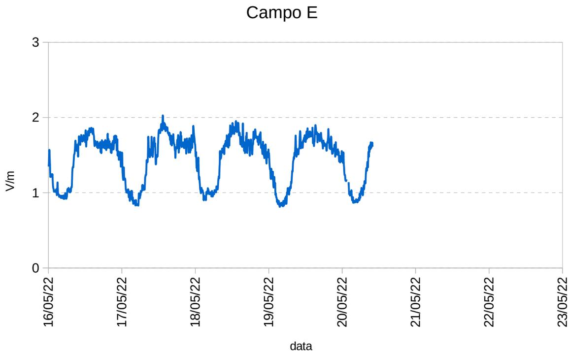
**Campo elettrico a banda larga – misura a lungo termine**
