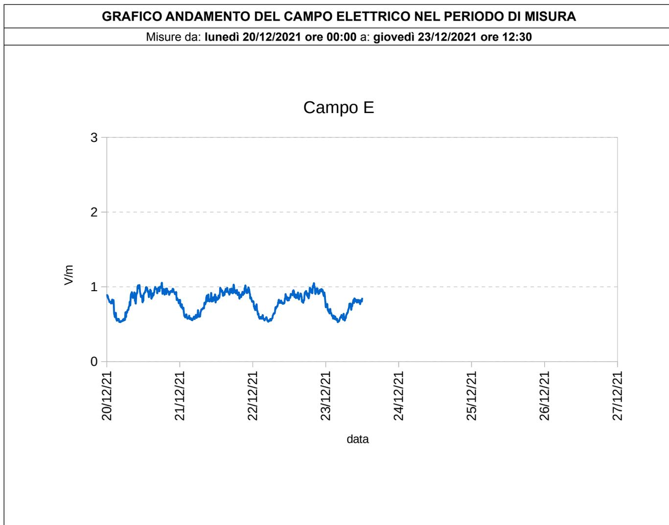
**Campo elettrico a banda larga – misura a lungo termine**
