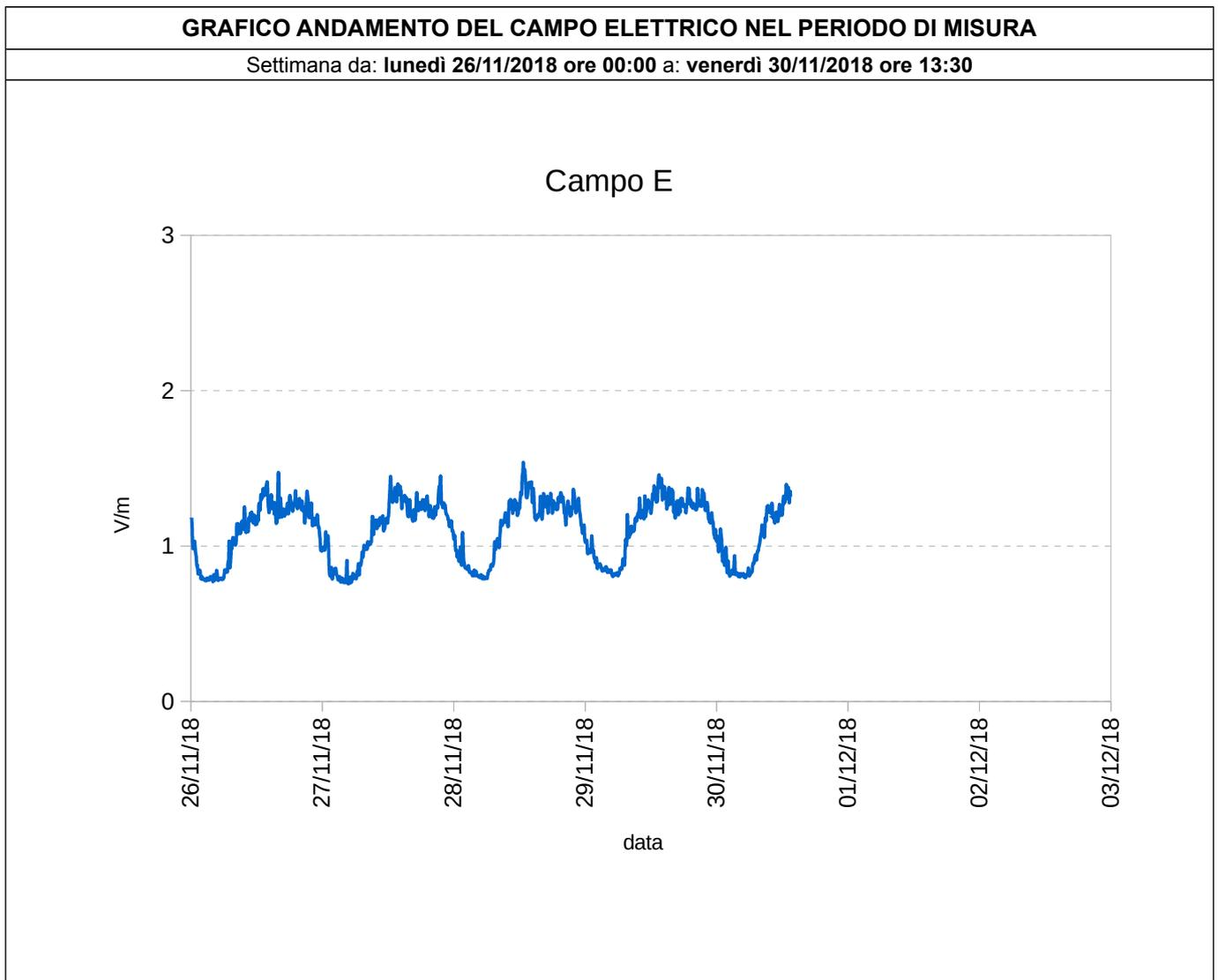
**Campo elettrico a banda larga – misura a lungo termine**
