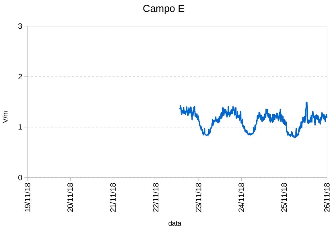
**Campo elettrico a banda larga – misura a lungo termine**
