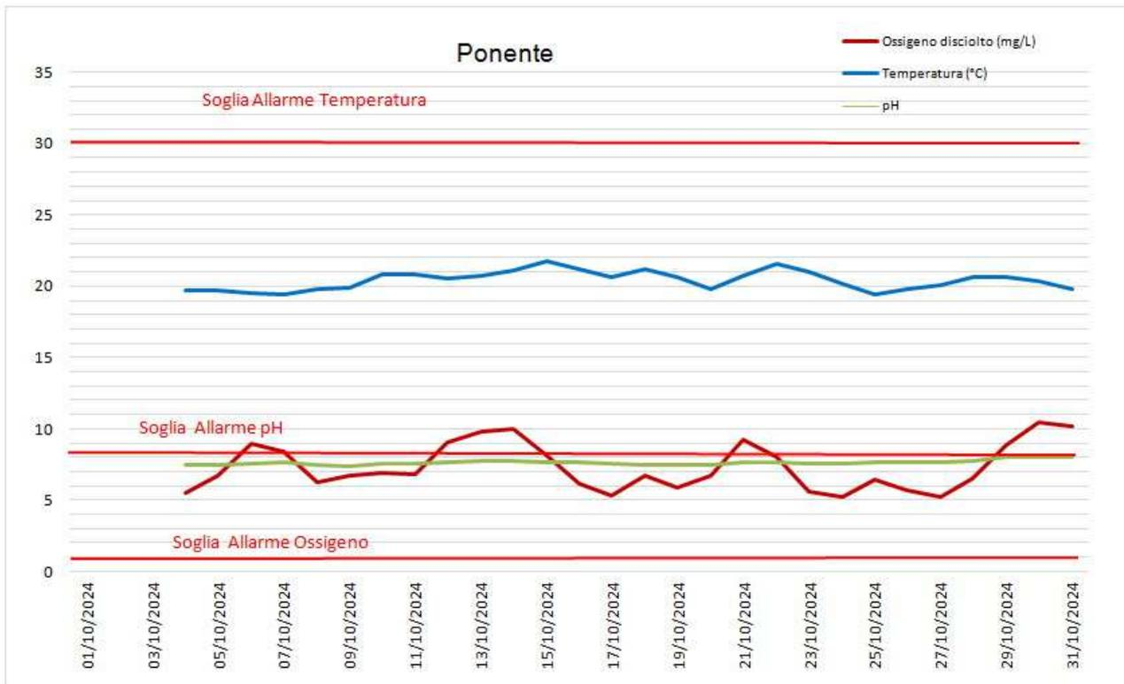
Figura 13 - Andamento medio giornaliero e Soglie di Allarme per i parametri Temperatura, pH ed Ossigeno disciolto registrati dalla sonda multiparametrica Ponente.
