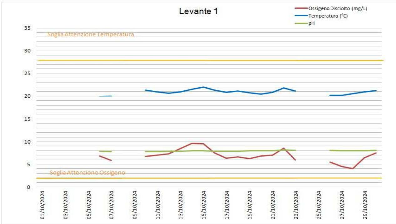
Figura 8 – Andamento medio giornaliero e Soglie di Attenzione per i parametri Temperatura, pH, Ossigeno disciolto registrati dalla sonda multiparametrica Levante 1. Il pH non presenta Soglie di Attenzione (ma solo di Allarme).
